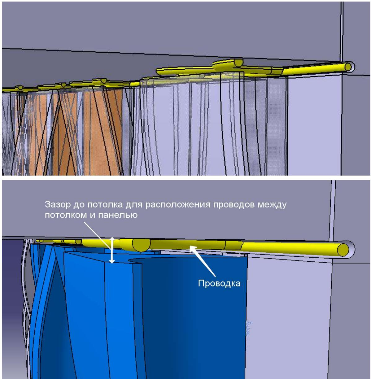
**Рис 8. Расположение подводящего провода**
