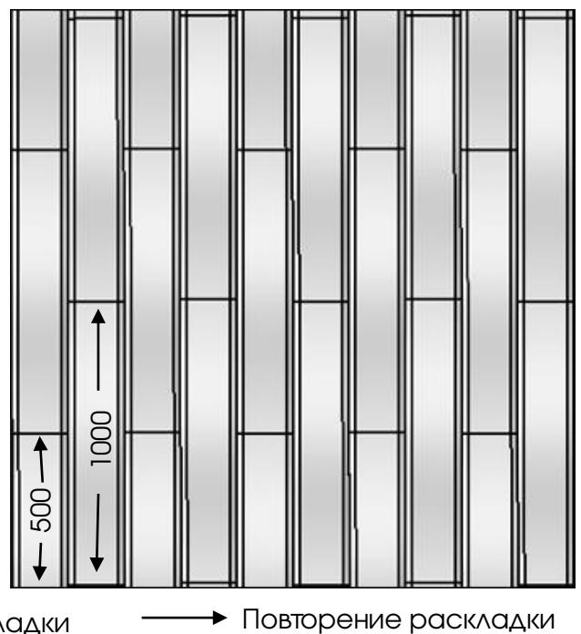
**Рис. 2б Раскладка Checkmate**
